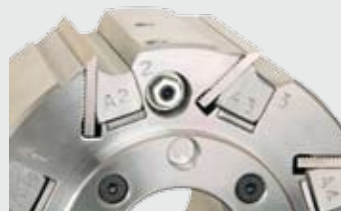
Простота в обігу і відмінне балансування завдяки нумерації притискних планок і відповідних каналів для відводу стружки
