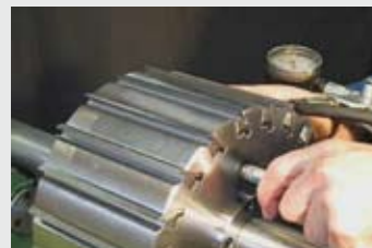
Швидка зміна ножів завдяки швидкозатискній системі
